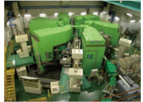
大型加速器：粒子は中心部から外側へと螺旋状に加速される。加速されると粒子の質量は大きくなるので、外側の磁極幅が広くなっている。
